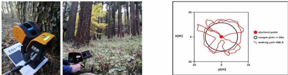
Laser mobile portatile che fornisce 300.000 misurazioni al secondo fino ad una distanza massima di 100 metri. A destra ritrovate il percorso a stella all'interno dell'area di saggio
